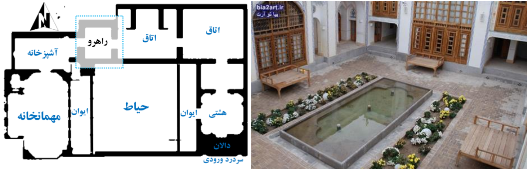
تصویر ۱۴. راهرو در خانه‌های سنتی منطقه آذربایجان و موقعیت آنها در پلان خانه
